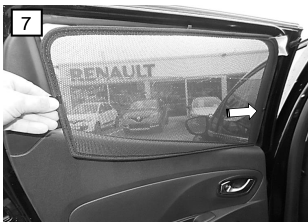
Der Halter wird unter dem Gummi auf das Blech gesteckt
